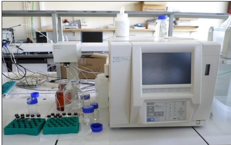
**Matériel :** Analyseur TOC (Carbone Organique total) –VsCH de Shimadzu. Logiciel TOC – Control V.2
