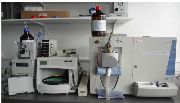
**Matériel :** pompe quaternaire GP40 Dionex, Spectromètre de masse LQC Fleet (Thermo Scientific) avec source ESI et passeur d'échantillon. Logiciel X Calibur version 2.0.7
