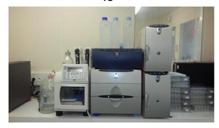
**Matériel:** Chromatographe ICS3000 (DONEX) colonne AS11HC (DIONEX) pour la séparation des anions et CS16 pour la séparation des cations et détecteur conductimétrique (DIONEX) Logiciel Chromeleon version 7.2
