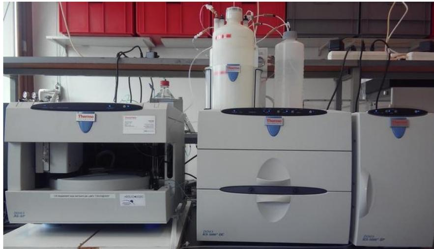
**Matériel :** Chromatographe ICS-5000+ à détection ampérométrique pulsée(DIONEX).
