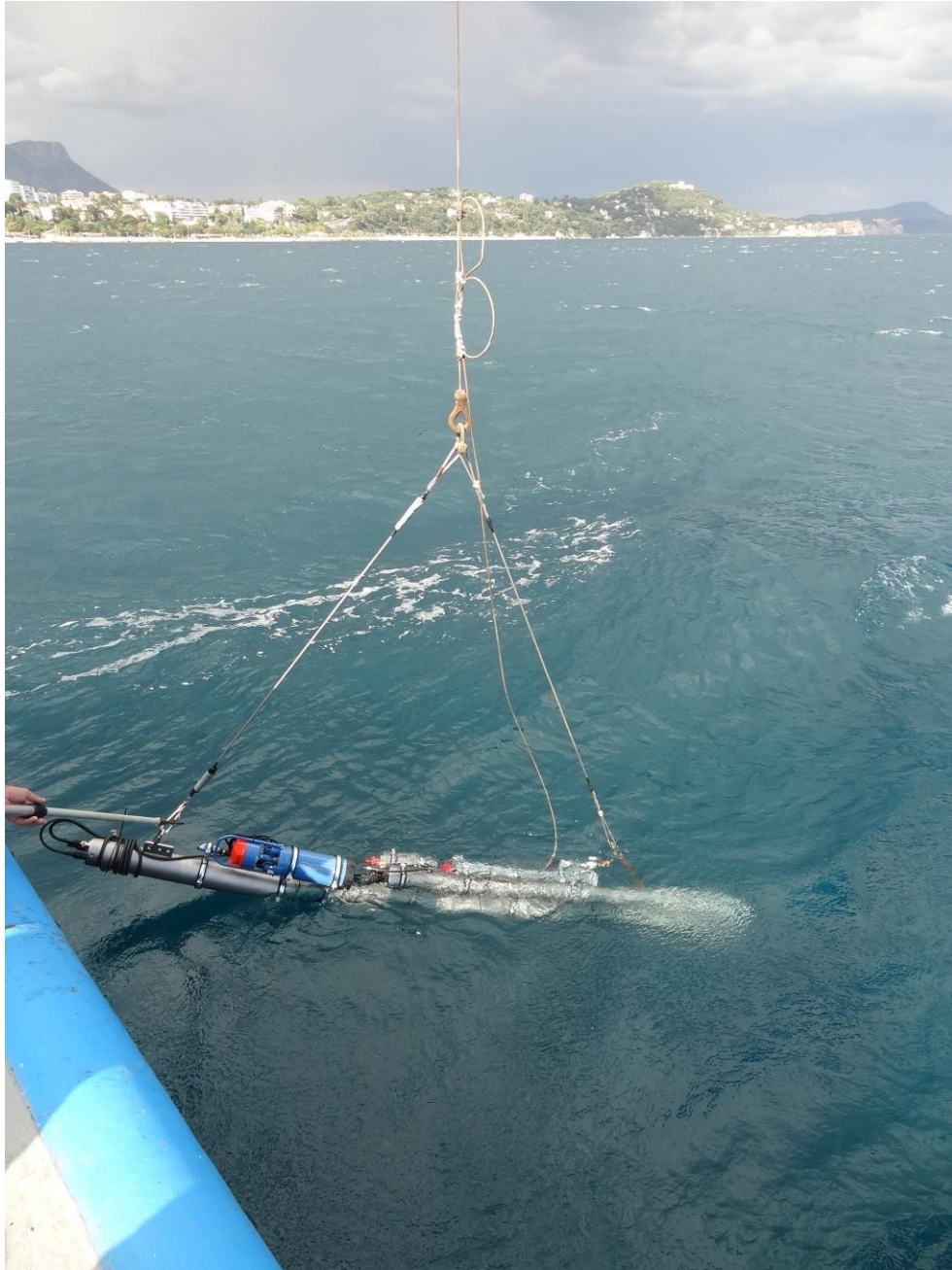
Légende : premier déploiement de l'instrument de type SARA en Méditerranée. Crédit : Jérôme Chappellaz (LGGE, OSUG, CNRS/UJF).
