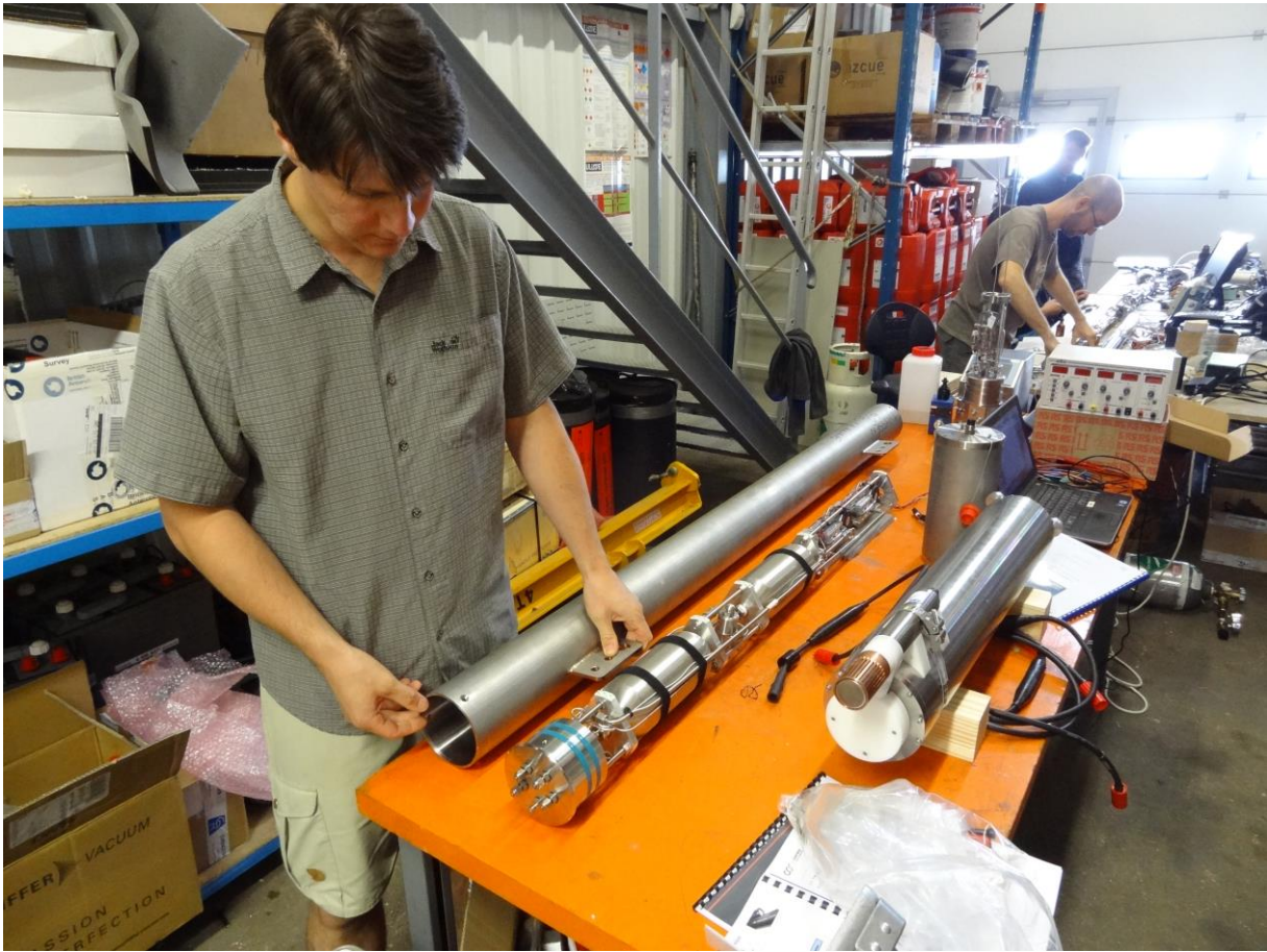
Légende : le système de gestion de l'échantillon gazeux. Crédit : Jérôme Chappellaz (LGGE, OSUG, CNRS/UJF).
